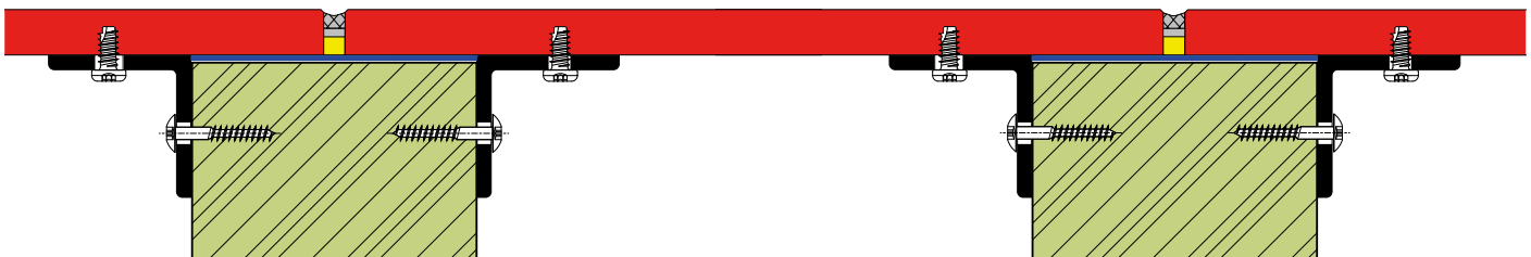
BALKONBODENPLATTE AUF HOLZTRAM VERDECKT BEFESTIGT (GESCHRAUBT)
